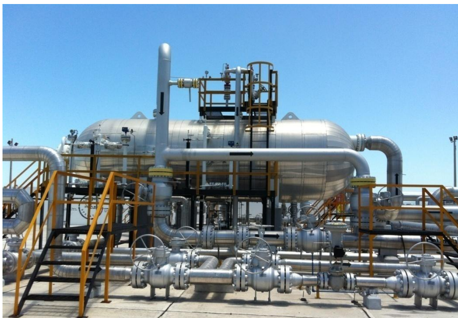
Figura 5.21.- Separador horizontal trifásico de alta presión
