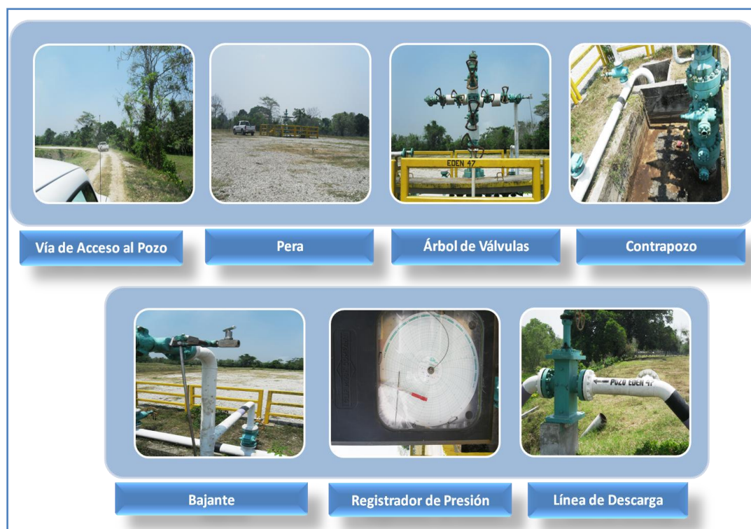
Figura 3.6.- Fotografías del Estado Actual del Pozo
