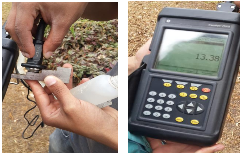
Figura 32 Calibración y uso de equipo ultrasónico.
