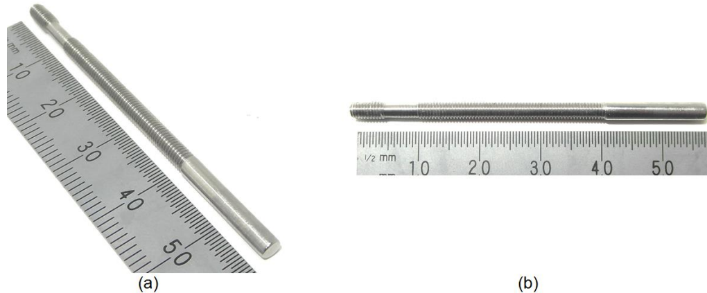
Figura 4.10. (a) Isométrico y (b) vista superior del actuador fabricado en acero inoxidable 304.
