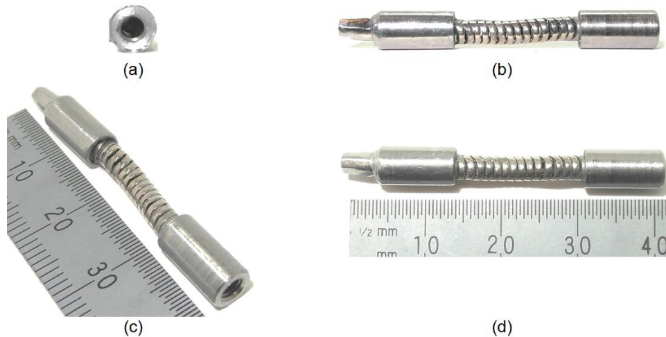
Figura 4.11. (a) Vista lateral, (b) vista frontal, (c) isométrico y (d) vista superior del activador fabricado en acero inoxidable 304.
