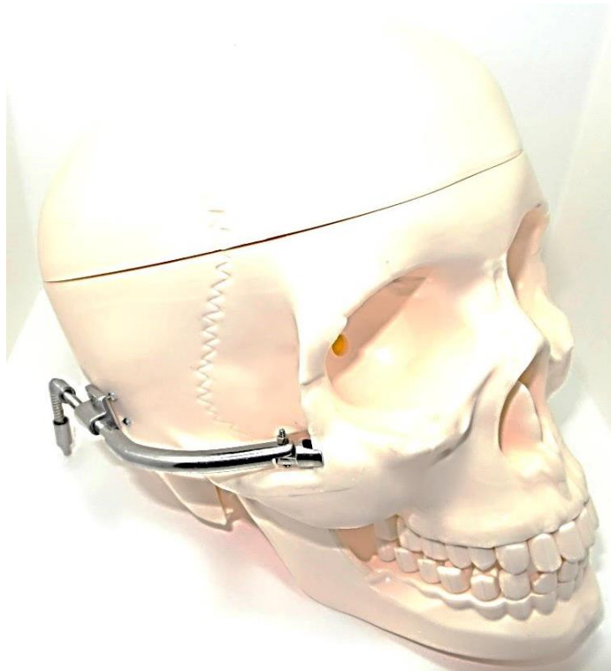
Figura 4.19. Montaje del distractor con pieza de transmisión con curva menor.
