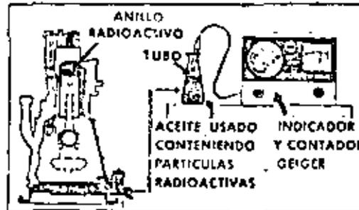
Se puede medir el régimen de desgaste del motor, por el grado de radioactividad que indica un contador Geiger sobre el aceite usado.
