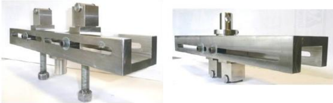
Figura 2.9 Soportes para ensayo de flexión en cuatro puntos. (Jiménez, 2009)
