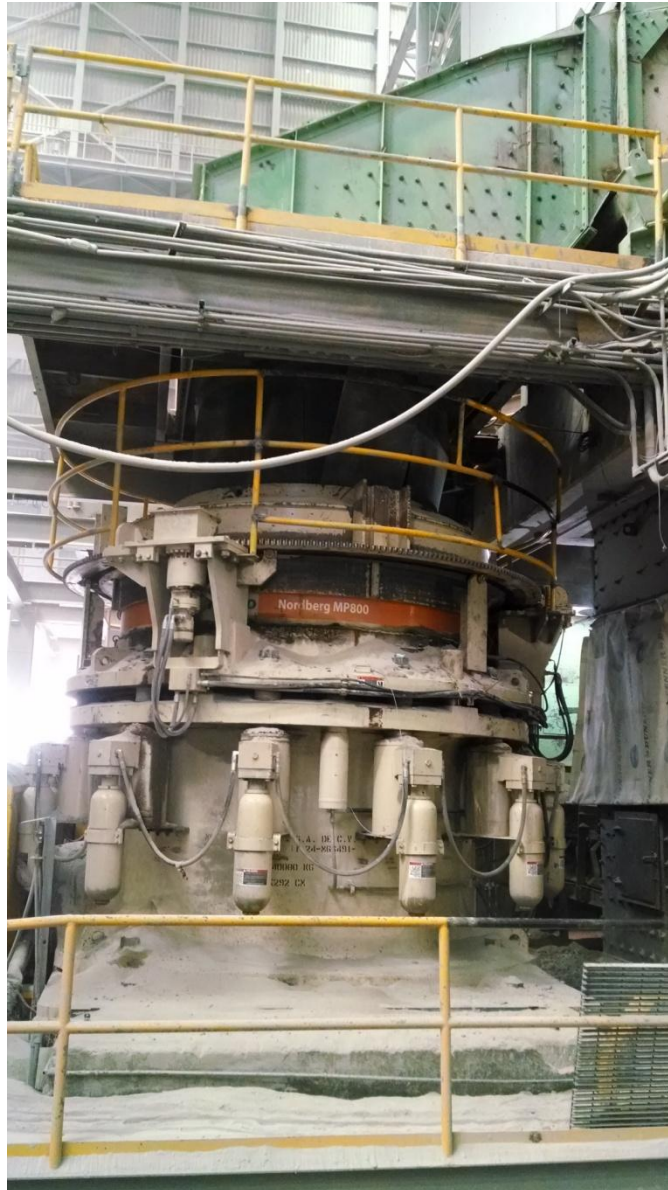
FIG. 2.67 Descarga de gruesos de la criba a la quebradora secundaria
