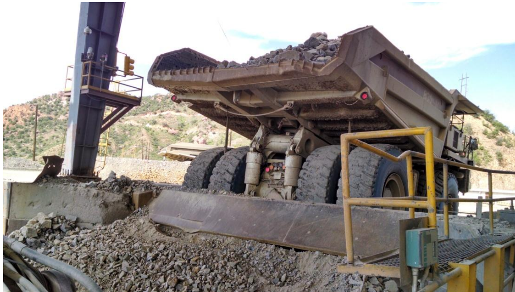
FIG. 2.55 Camión fuera de carretera en posición para descargar en quebradora primaria
