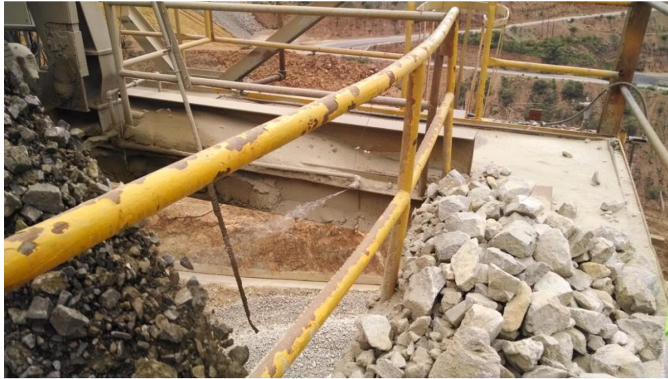
Fig. 2.35 Golpes por sobre aceleración de la banda 2
