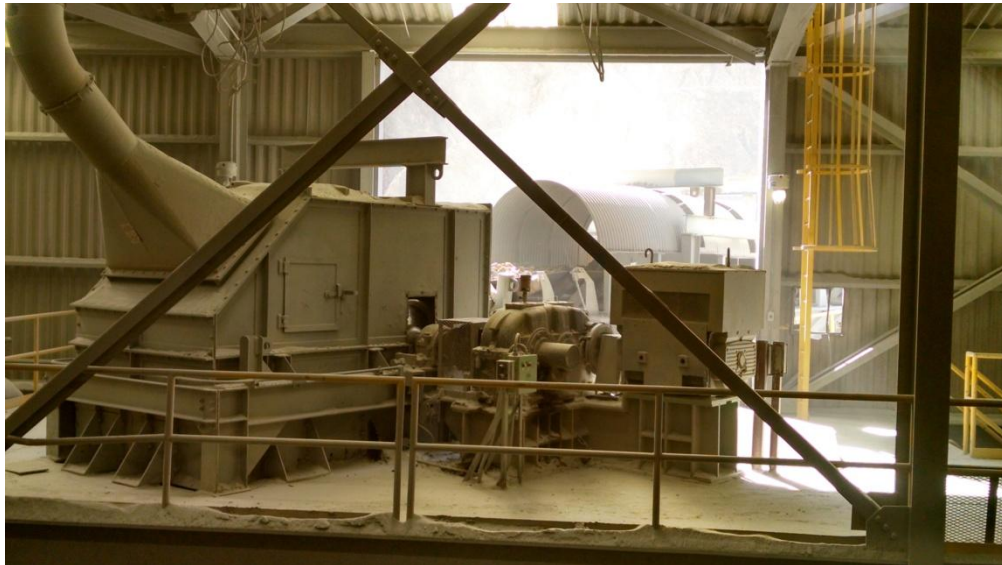
FIG. 2.37 Chute de transferencia de banda 3a a tripper 4a
