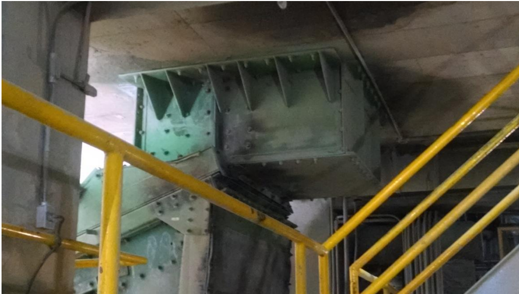
FIG. 2.18 Alimentación a criba de quebradoras secundarias
