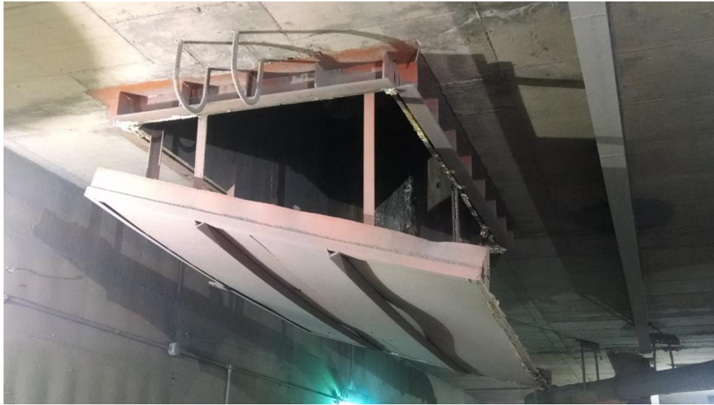
FIG. 2.8 Espacio para colocar descarga de almacén de gruesos a alimentador en lado A
