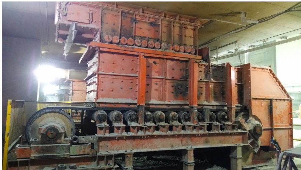
FIG. 2.17 Alimentador de bandas a cribas de quebradoras secundarias
