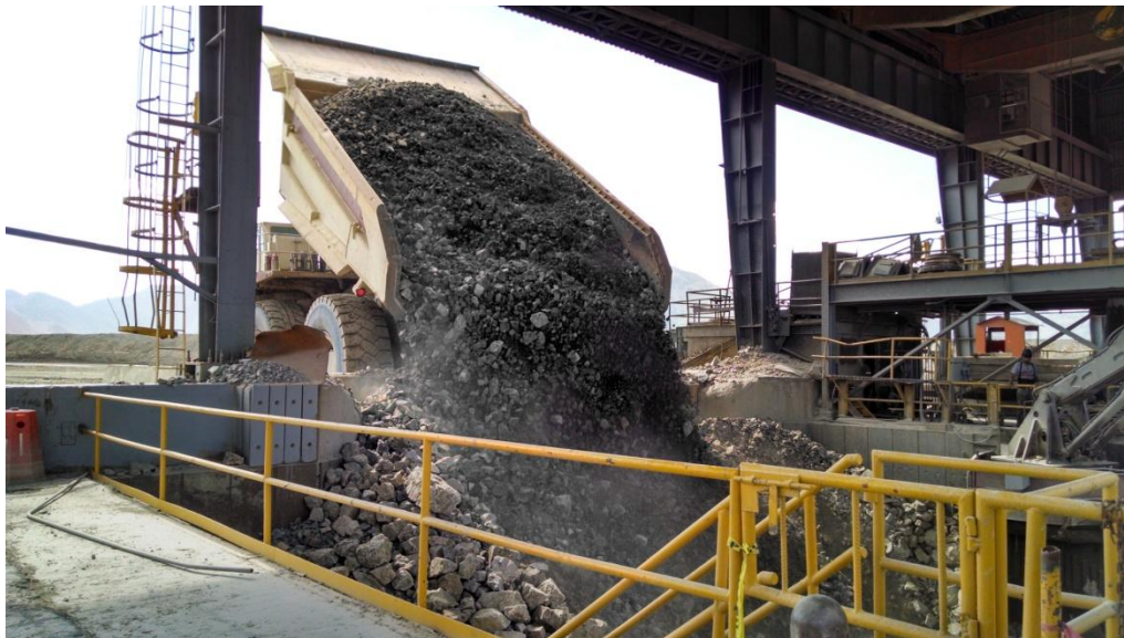
FIG. 2.56 Camión fuera de carretera descargando en uno de los lados de la quebradora primaria
