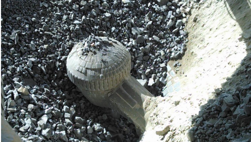
FIG. 2.57 Quebradora primaria giratoria con carga
