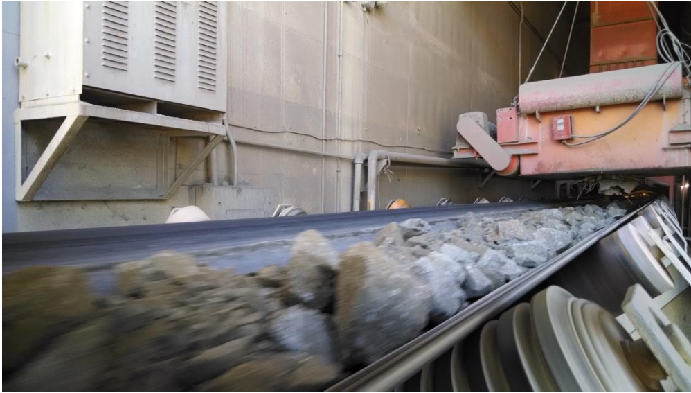
FIG. 2.36 Electroimán instalado en banda 3ª
