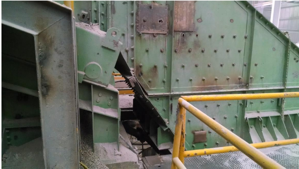
FIG. 2.69 Vista lateral de una criba con inclinación de 20°
