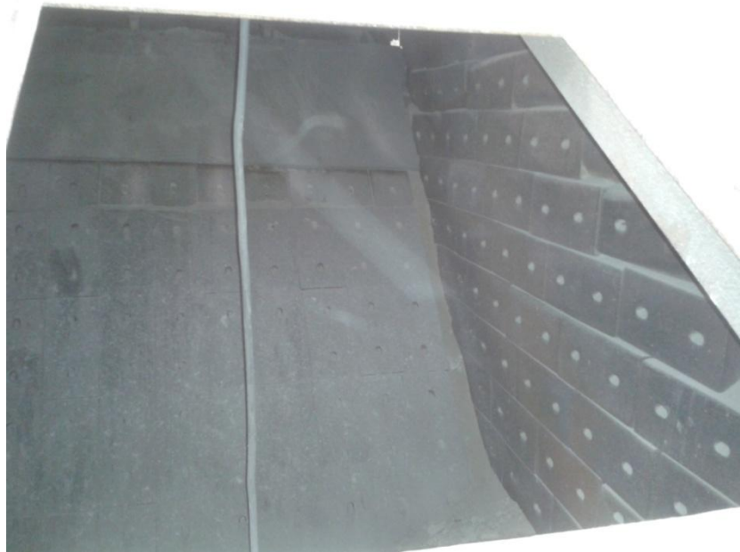
Fig. 2.72 Interior de una criba vibratoria
