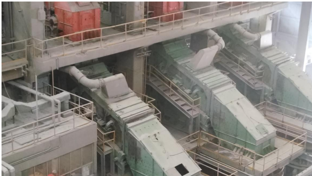
FIG. 2.19 Alimentadores y cribas de quebradoras secundarias
