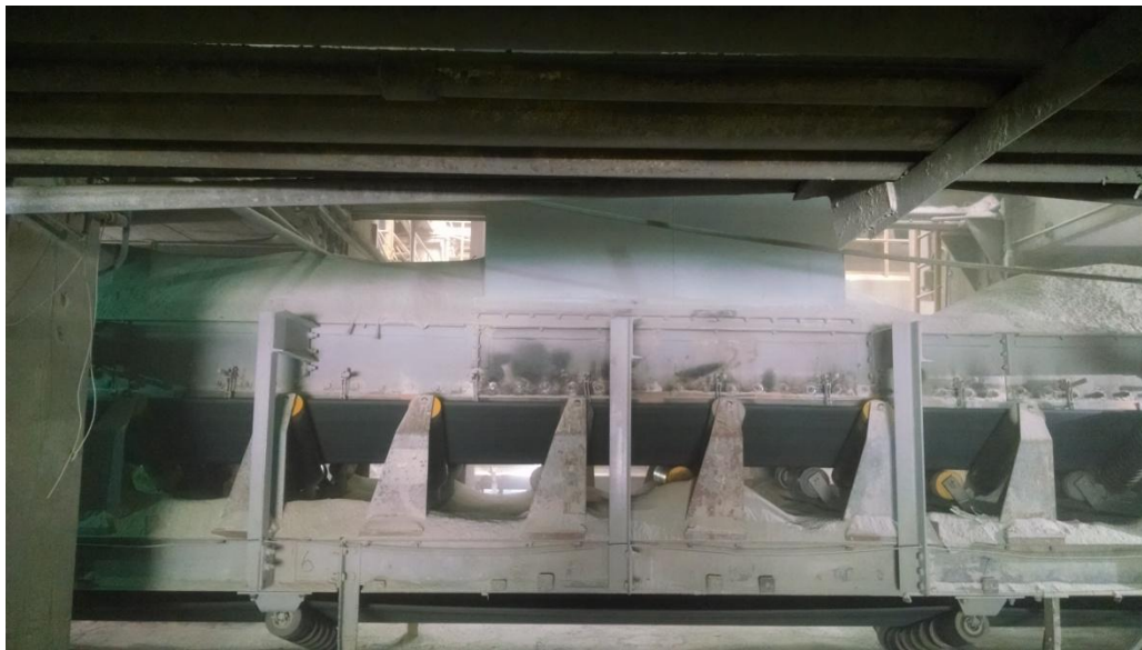
FIG. 2.44 Descarga de gruesos de quebradoras terciarias en banda 5a
