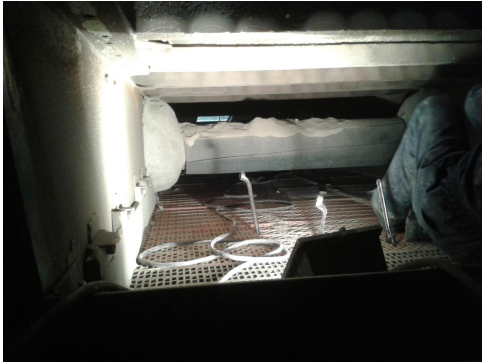
FIG. 2.70 Interior de una criba con malla de \frac{1}{2} "
