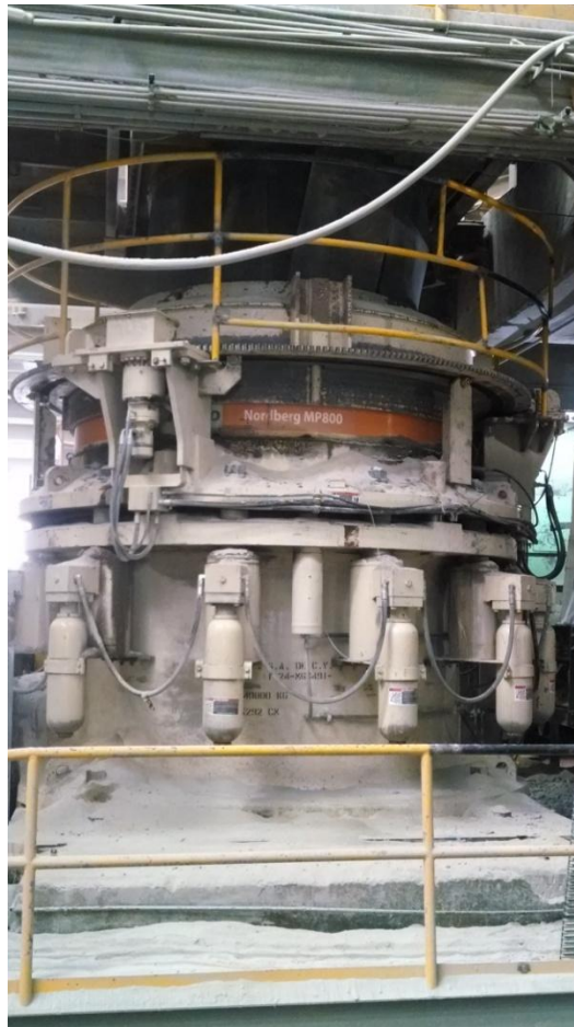
FIG. 2.61 Quebradora secundaria METSO MP800
