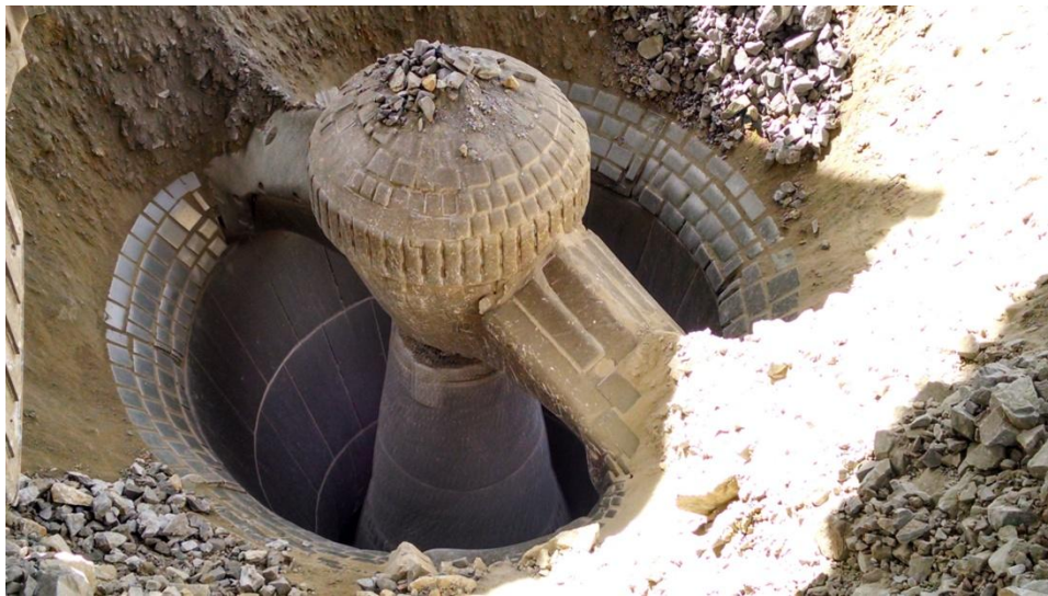
FIG. 2.54 Quebradora primaria de cono giratoria
