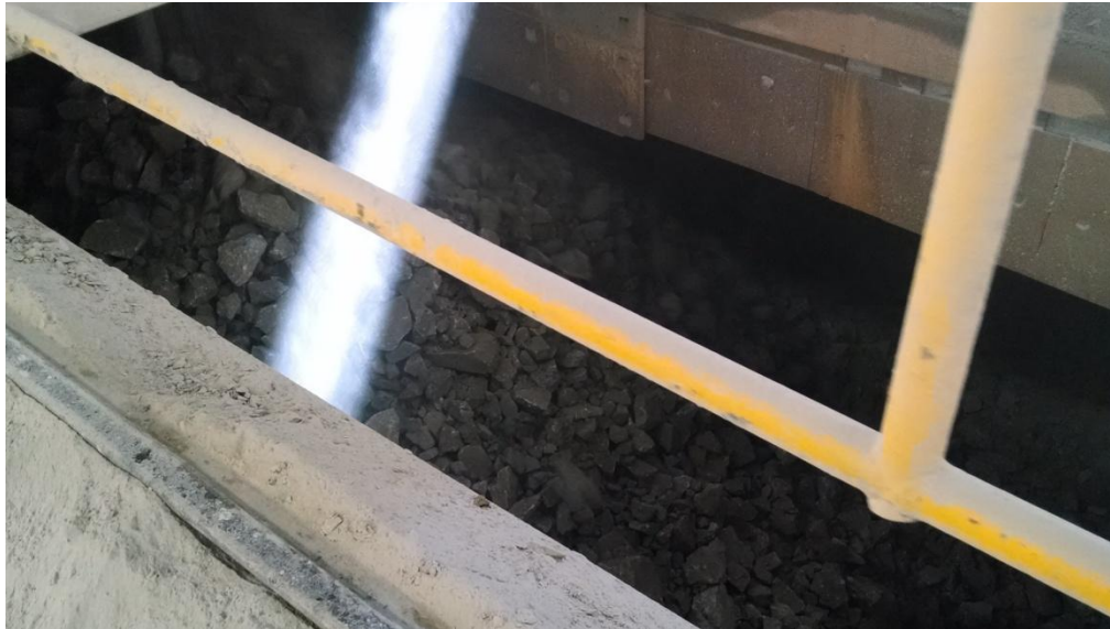
FIG. 2.14 Tolva de compensación de quebradoras secundarias llena
