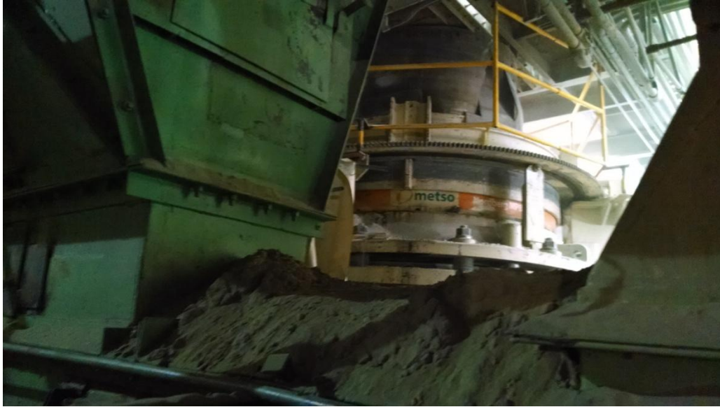
FIG. 2.20 Descarga de finos de cribas en banda 9
