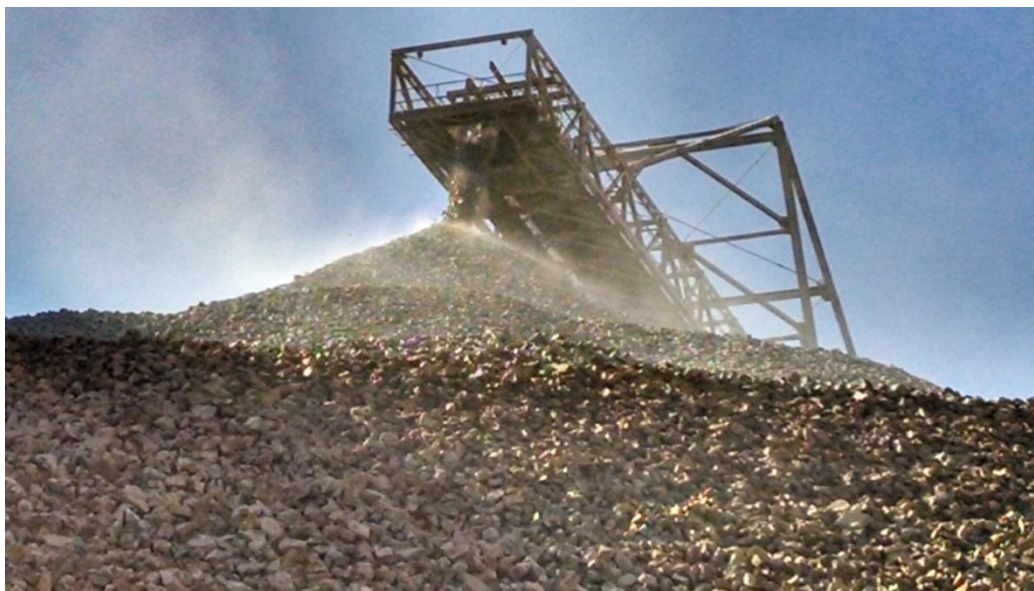
FIG. 2.1 Descarga del mineral en el almacén de gruesos
