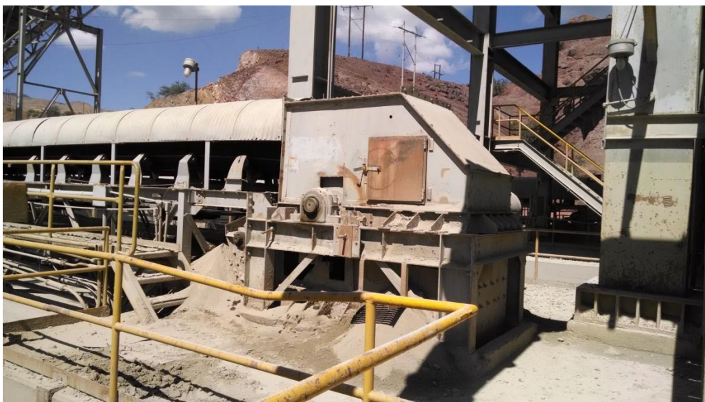
FIG. 2.21 Chute de transferencia de banda 9a a banda 10a
