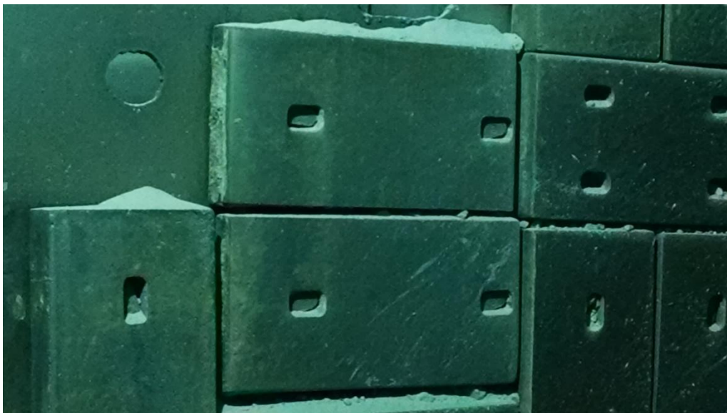
FIG. 2.30 Revestimiento del chute del alimentador a la banda 1
