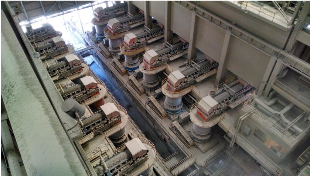
FIG. 2.63 Vista aérea de las dos secciones de trituración terciaria
