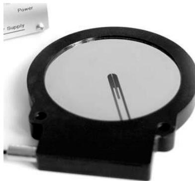
Figura 1.7. Hidrófono de membrana.
