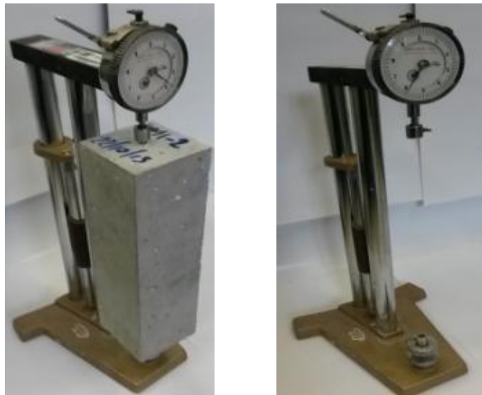
Imagen 2.3. Tipo de aparato adecuado para la medición de las variaciones de longitud en especímenes prismáticos.
