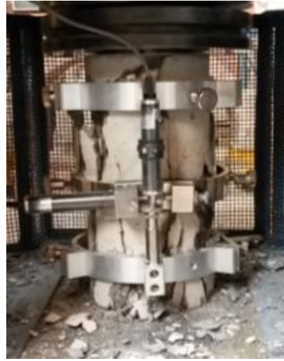
Figura D. Ensayo para las pruebas de módulo de elasticidad y relación de Poisson.
