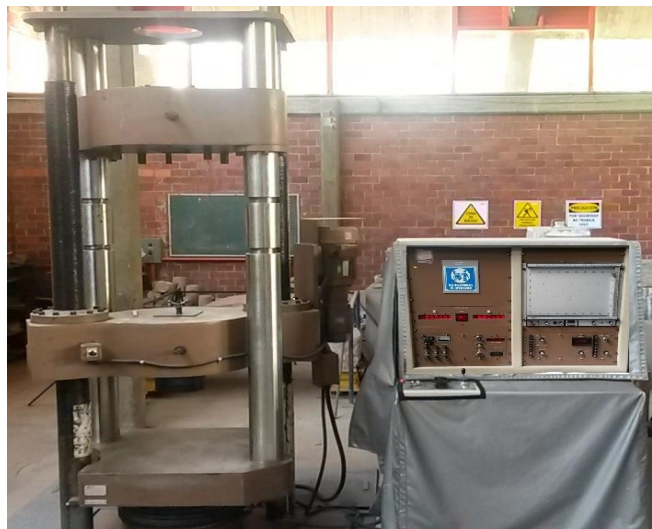
Imagen 2.1. Fotografías del equipo completo de "Universal Testing Machine".
