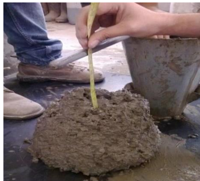
Imagen 4.1. Ensaye de revenimiento
