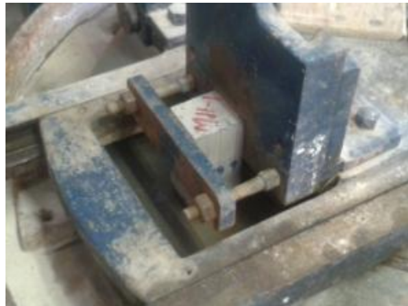
B) Fotografía de la colocación del espécimen prismático
