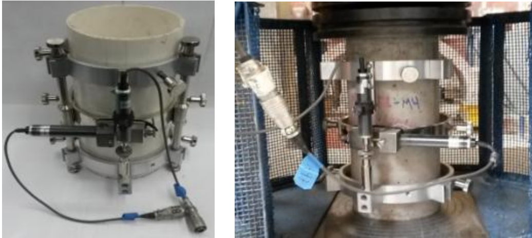
Imagen 2.2. Fotografías del equipo para la prueba de módulo de elasticidad y relación de Poisson junto con la muestra de la colocación en especímenes.
