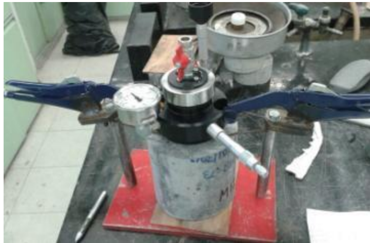
Imagen 2.6. Fotografía del aparato GWT con adaptación hacia medios cilindros.
