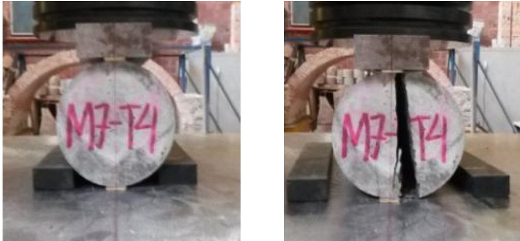
Figura B. Ensayo de tensión por compresión diametral.
