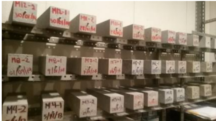
Imagen 4.3. Fotografía tomada de la cámara seca con los especímenes realizados en el estudio.
