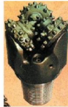
Fig.19 Barrena tricónica y la orientación de los ejes 63 .
