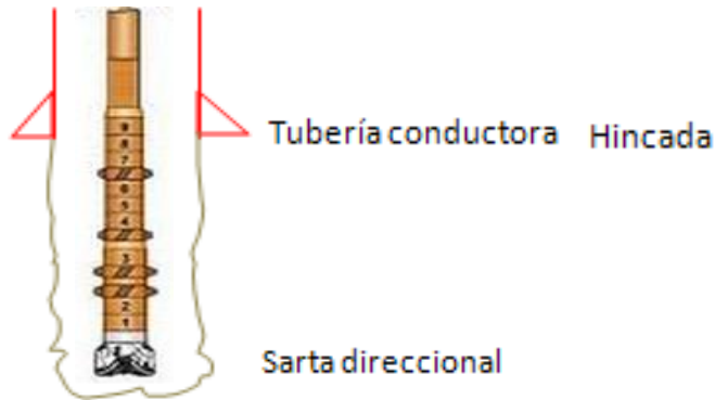
Fig.61 avance en la perforación hasta 700m del pozo Brillante 20.
