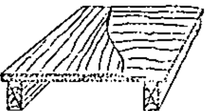
Triplay usado en la dirección más resistente.
