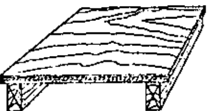
Triplay usado en la dirección menos resistente.
