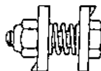
Para conexiones ajustadas sobre resortes, donde la tuerca debe permanecer fija o está sometida a ajuste.
