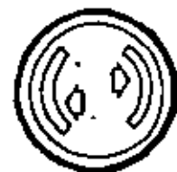
DOBLE ZAPATA GUIADA LA DIRECCION DE ROTACION NO PROVOCA LA AUTOENERGIZACION
