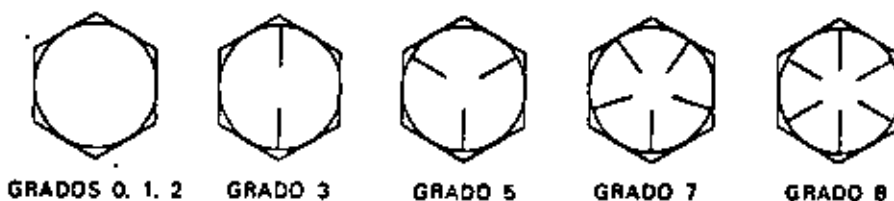
Fig. 10.14 Identificación de cabezas de pernos
