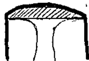
FIG. 1.8 SECCION DE UNA POLEA ABOMBADA
