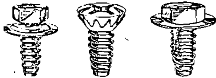
(B) TORNILLOS ATERRAJANTES CON ARANDELAS PREENSAMBLADAS. SE ENCUENTRAN DISPONIBLES CON UNA GRAN VARIEDAD DE FORMAS DE ROSCAS, ESTILOS DE CABEZA Y CONFIGURACIONES DE LA ARANDELA.
