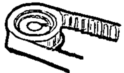
FIG. 1.5 BANDA SINCRONA O DENTADA Y SU POLEA
