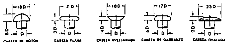
(A) TIPOS CORRIENTES DE CABEZA Y PROPORCIONES APROXIMADAS
