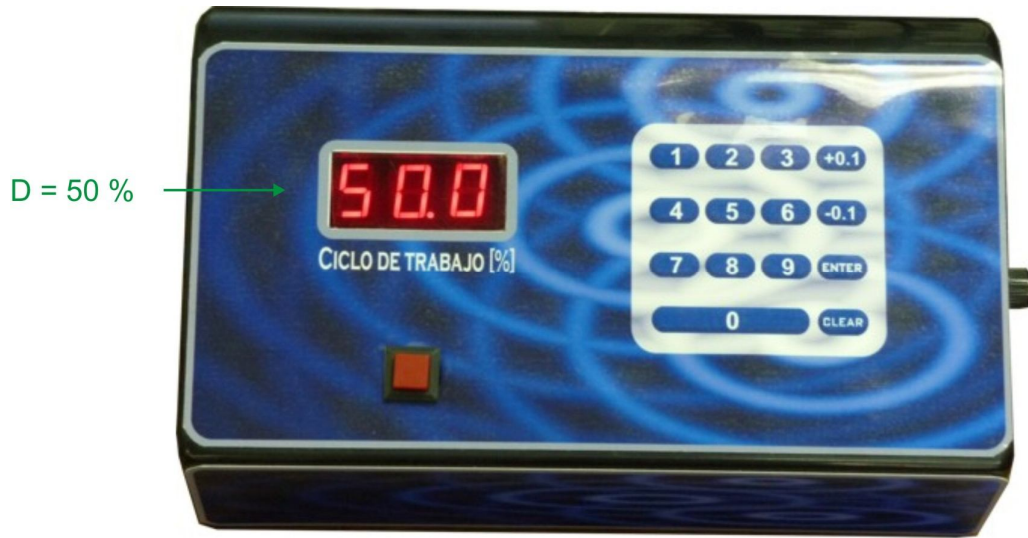
Figura 30. Ciclo de trabajo mostrado en el sistema
