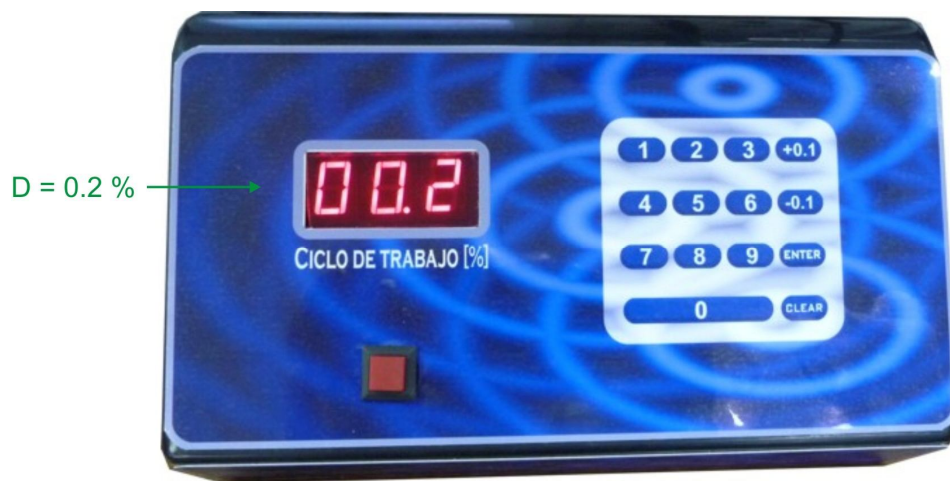
Figura 24. Ciclo de trabajo mostrado en el sistema.
