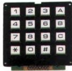
Figura 6. Teclado matricial 4x4 tipo telefónico.
