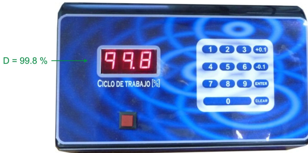
Figura 26. Ciclo de trabajo mostrado en el sistema.
