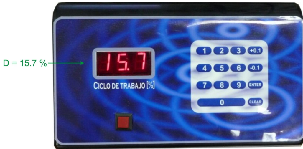
Figura 28. Ciclo de trabajo mostrado en el sistema.
