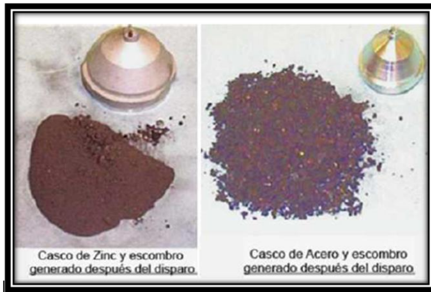
FIGURA (2,4)- ESCOMBROS GENERADOS POR EL CASCO DE CARGA BH.
