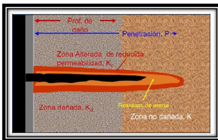
FIGURA (12,1)-. RESIDUOS DE ARENA EN TÚNELES DE DISPARO
