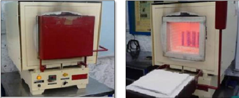
Figura 2.5. Horno industrial para tratamientos térmicos KINTEL AX-2.
