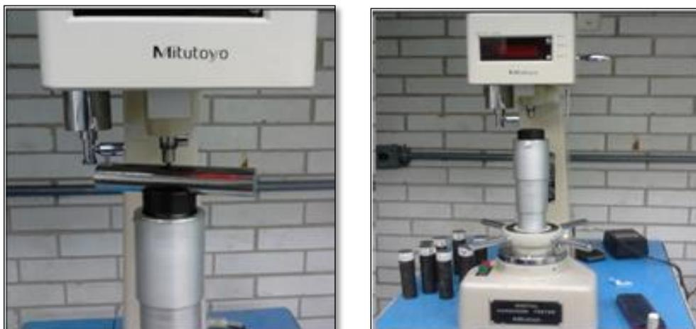
Figura 2.6. Durómetro MITUTOYO ROCKWELL.
