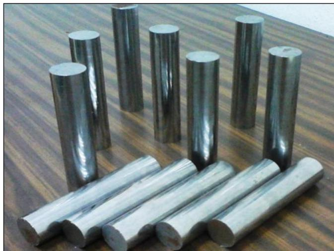
Figura 2.1. Probetas de Acero 8620.
