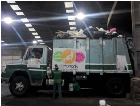
Figura 49: Vehículo carga trasera y descarga manual de bolsas y bultos
