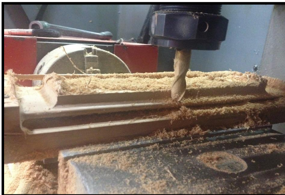
Figura 5. 7 Fresado de la cara inferior del ala (Intradós).
