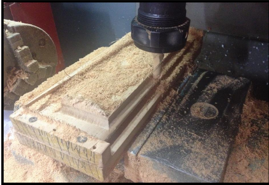
Figura 5. 8 Fresado de la cara superior del ala (Extradós).
