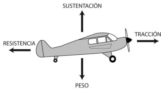
Figura 1. 2 Representación de las cuatro principales fuerzas que actúan durante el vuelo.
