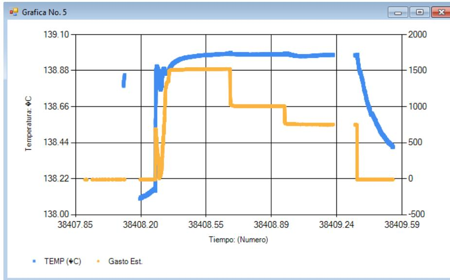
Fig. V.5: Resultado del cálculo del gasto a partir de la rotación
