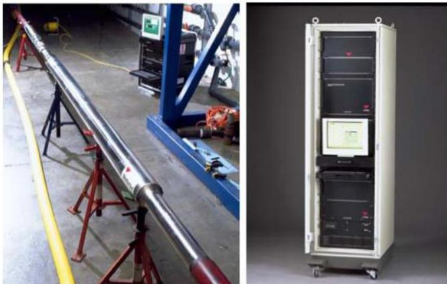
Fig. III.27: Sistema de medición de flujo totalmente ensamblado y su unidad de instrumentación superficial asociada (Fuente: T.K. Kragas, F.X. Bostick, and C. Mayeu, paper SPE 77655 presented at the SPE Annual Technical Conference and Exhibition held in San Antonio Texas, September 29-October 2, 2002)
