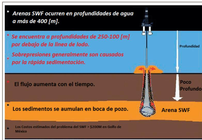
Fig.3.11.-Problema de flujo de agua superficial se encuentran en perforación en aguas profundas.<sup>3.11</sup>
