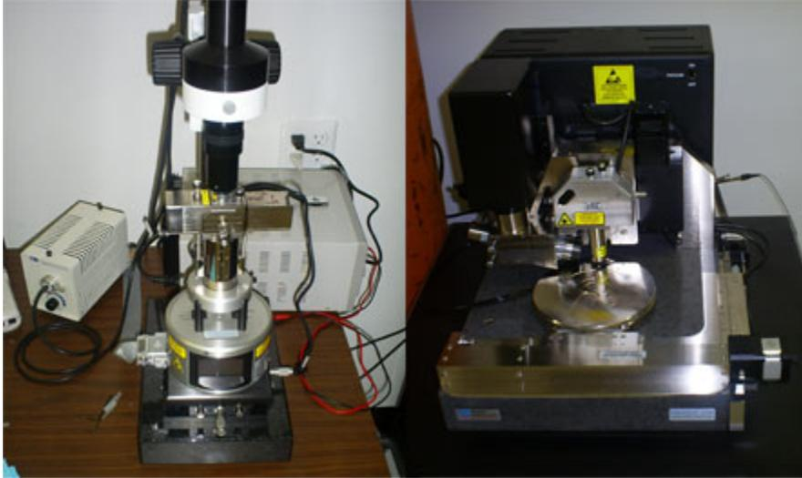
Fig.1.4.-Microscopio de fuerza atómica (AFM).<sup>1,4</sup>
