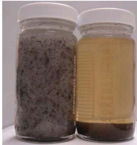
**Fig.4.3.**-Surfactante en suspensión después de un tiempo con una temperatura de 800F, la muestra de la izquierda es un fluido con nanopartícula y el otro es sin nanopartículas.<sup>4.3</sup>
