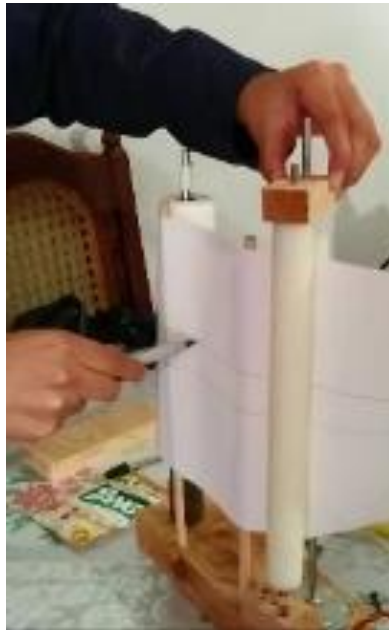
Figura 6. 6 En la prueba el plumón solo es sostenido mientras el papel se mueve
