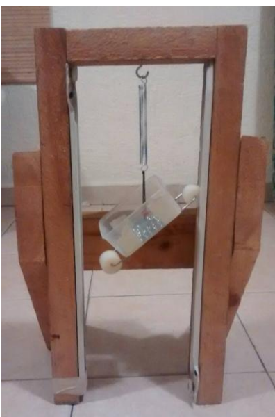
Figura 4. 9 Al sujetar la caja al resorte por su parte central las ruedas se salen de los rieles
