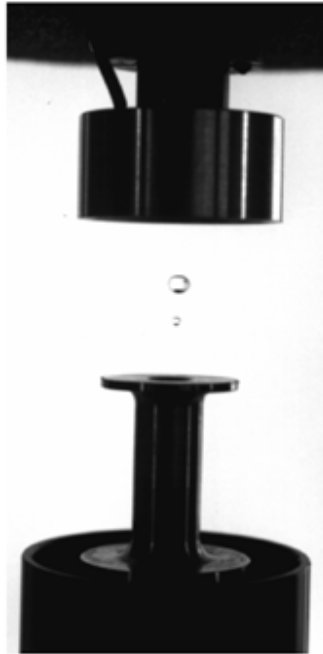
Figura 2.7 Gotitas levitadas en el tercer y segundo nodo de presión (Tec Five 1995).
