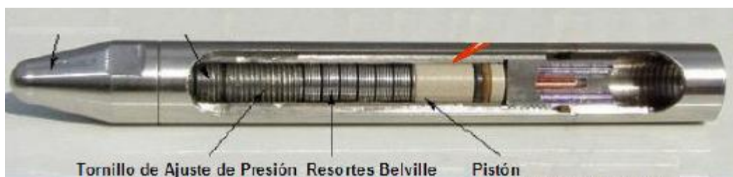
Figura 3.4 Boquilla de dosificación con regulación de presión de apertura. 2
