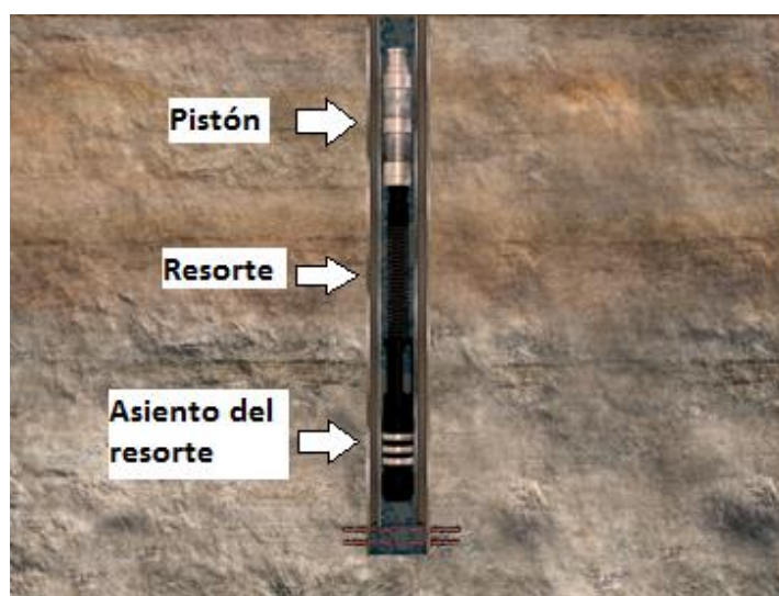
Figura 1.27 Equipo subsuperficial del sistema de Émbolo Viajero. 18
