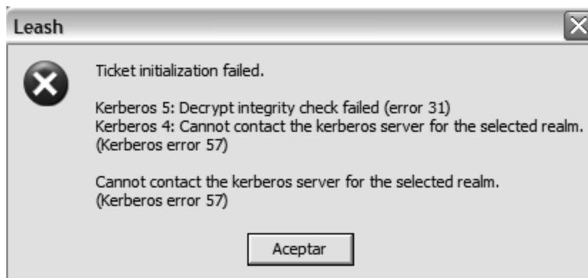
Figura 3-28. Ventana de error de conexión con servidor Kerberos.
