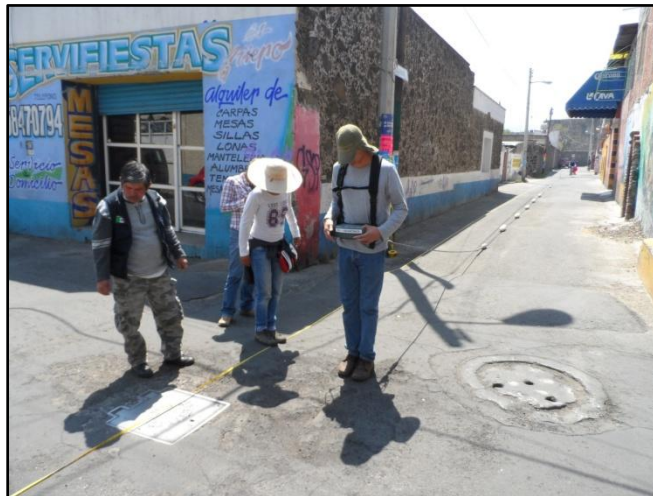
Figura 3.22 Adquisición de datos con equipo OhmMapper , calle Nicolás Bravo
