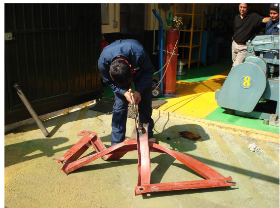
Figura 13d. Corte de muestras en las instalaciones del IMP.
