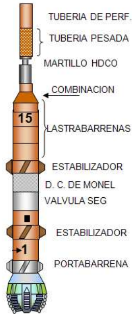
Figura 3. Sarta típica de perforación.
