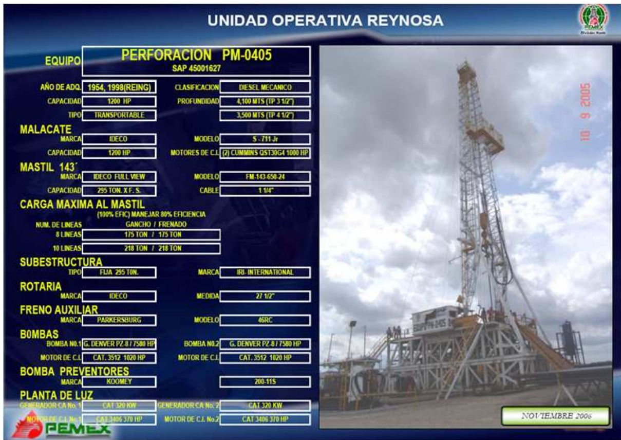
Figura 12. Datos adquiridos de la placa del mástil.
