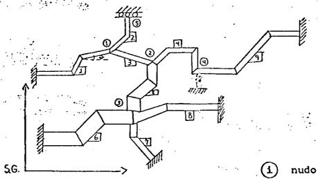
FIG. 2.- Tuberia en el plano. Notese que en un nudo pueden concurrir barras con diferente sección transversal.
