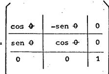
donde 0 minclinación del tramo de barra j referido al eje x positivo en el S.G. medido en sentido contrario al de las manecillas del reloj.
