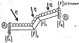
FIG. 6.- Barra 1 cargada y fuerzas de fijación  $\{F_a\}$   $\{F_b\}$
