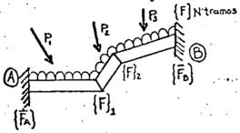
FIG. 6.- Barra [] cargada y fuerzas de fijación $[F_A]$   $[F_b]$
