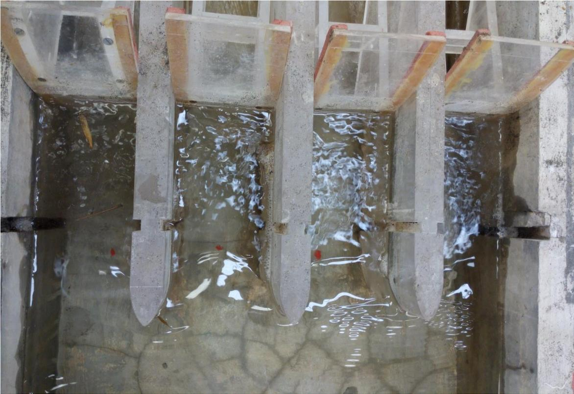
**Figura 3.7** Ondas estacionarias generadas por la operación de compuertas y la presencia de pilas
