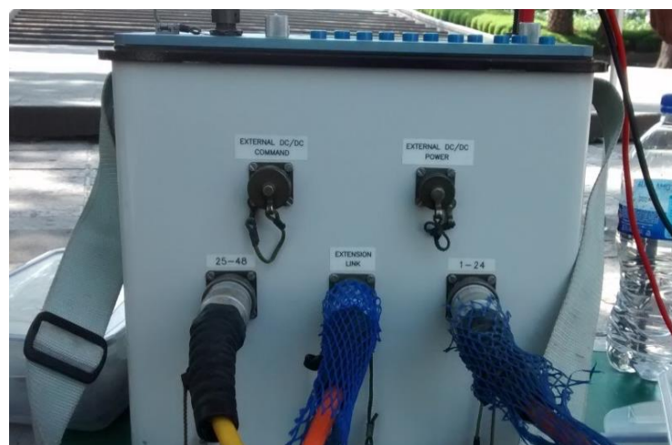
Figura 4.4 Resistivímetro SYSCAL Pro Switch conectado a cables para electrodos.
