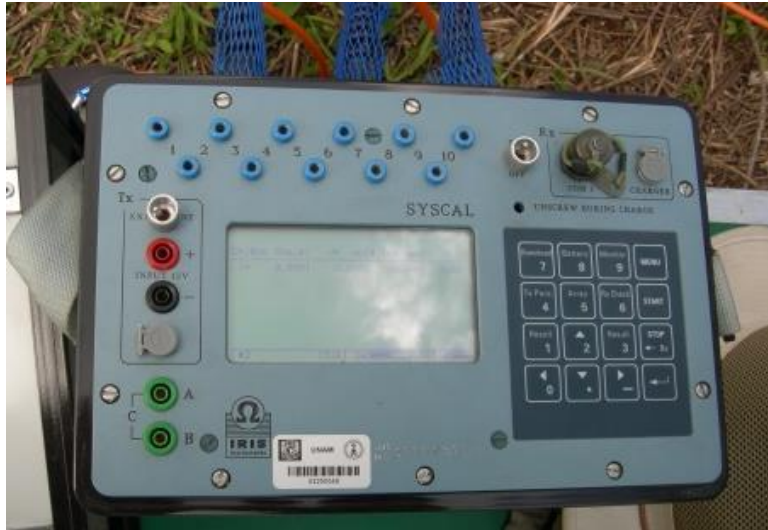
Figura 4.3 Resistivímetro SYSCAL Pro Switch de Iris Instruments.
