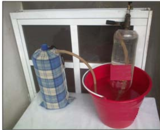
Figura 4. 9 Arreglo del reactor con cubierta aislante y almacenador del biogás.
