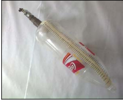
Figura 4. 4 Recipiente recolector de biogás
