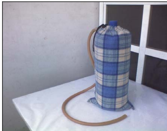
Figura 4. 8 Cubierta aislante del digestor.
