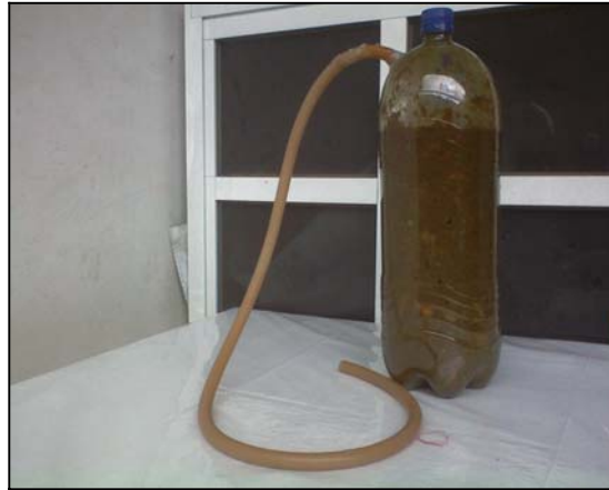
Figura 4. 7 Digestor con carga completa en el arranque.
