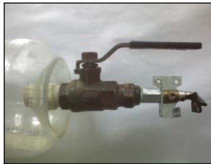
Figura 4. 5 Válvula de de quema para el biogás.
