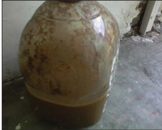
Figura 5. 8 Características del lodo digerido.
