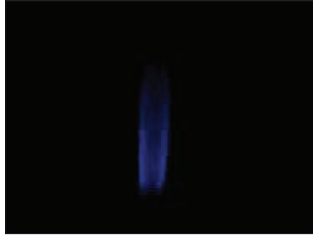
Figura 5. 14 Combustión del biogás generado en la segunda etapa de experimentación.
