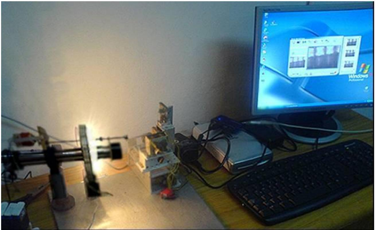
Figura 5.1 Captura de imágenes de tornillos con el sistema de visión
