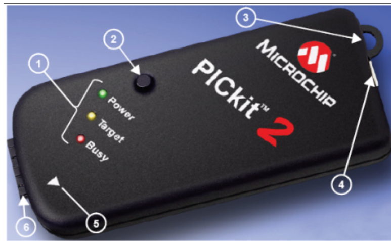
Figura 2.23 Programador PICKit 2. (1) LEDs de status. (2) Push-button. (3) Asa. (4) Conexión USB. (5) Marcador de pin 1. (6) Conector de programación.
