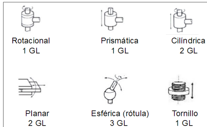
Ilustración 2. Articulaciones básicas. La letra G se refiere a los grados de libertad que permite cada articulación.
