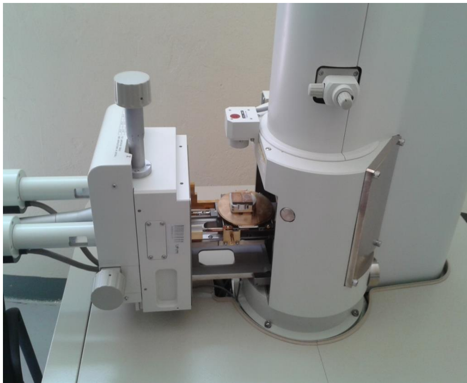
Figura 3.1. Microscopio Electrónico de Barrido marca JEOL donde se obtuvieron las micrografías, así como la realización del análisis por EDS
