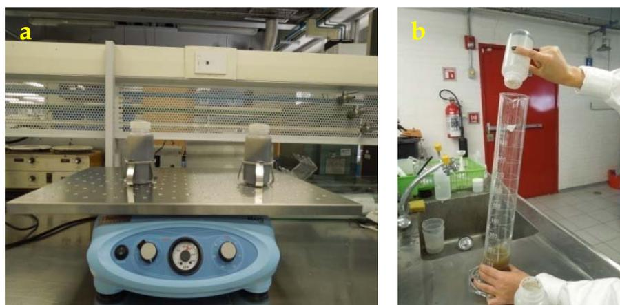
**Figura 5.5.** Procedimiento de extracción de los compuestos solubles: a) agitación y b) separación de las fases después de la centrifugación
