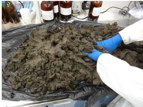
Figura 6.3. Mezclado de los residuos molidos para obtener la muestra homogénea
