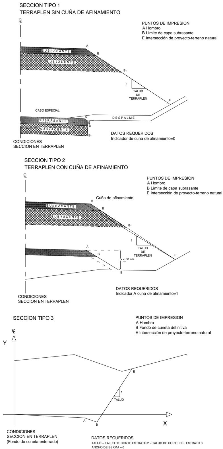
figura 6-1 Geometría de las secciones tipo de construcción
