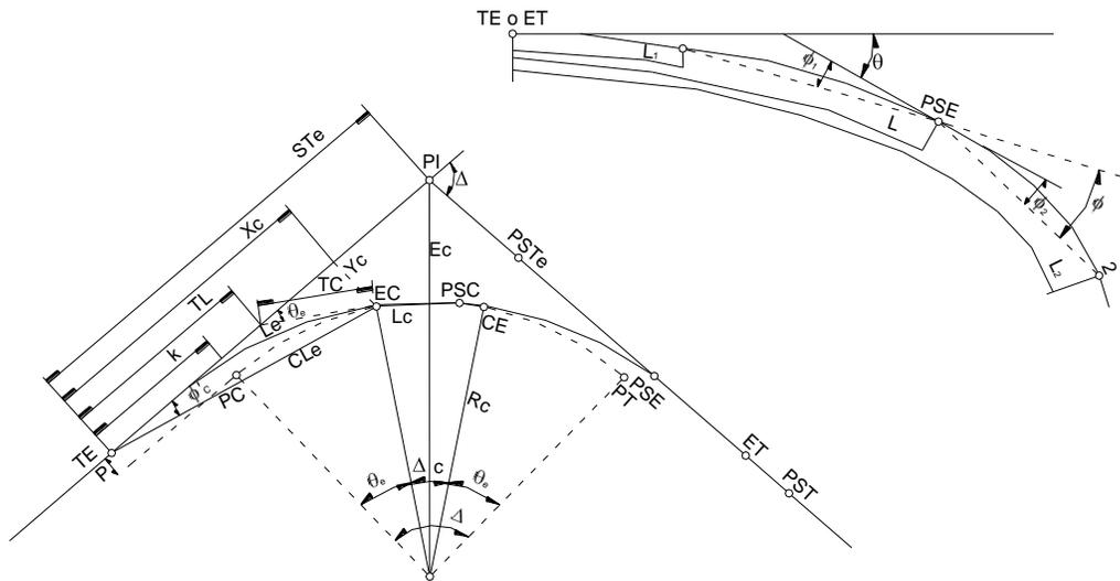
**figura 4-14** Elementos de la Curva Circular con Espirales
