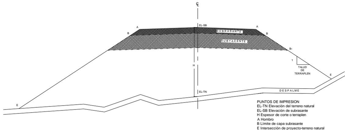
GEOMETRÍA DE LAS SECCIONES DE CONSTRUCCIÓN
