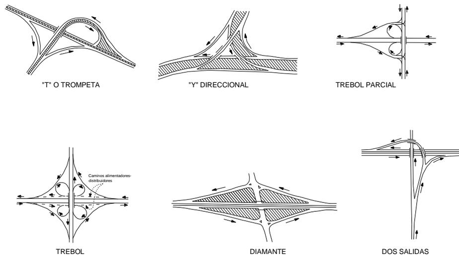
*figura 4-5 Tipos generales de entronques a desnivel*
