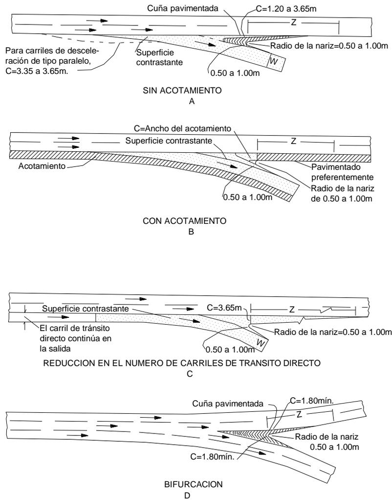
**figura 4-10** Diseños para los extremos de salida
