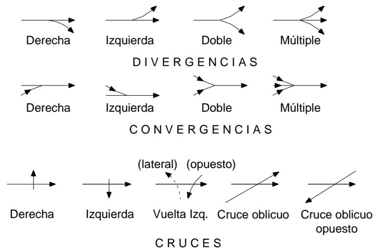
**figura 4-1** Maniobras de los vehículos en las intersecciones
