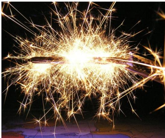
Figura 1.7 Corto circuito entre dos conductores.
