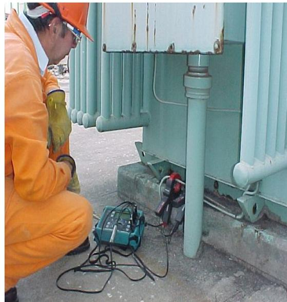
Figura 3.13 Medición de la puesta a tierra de carcasa.
