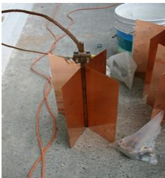
Figura 3.11 Electrodo de puesta a tierra tipo rehilte.
