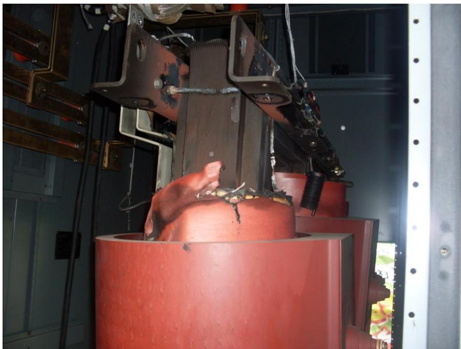
Figura 5.17 Daño a un transformador tipo seco.
