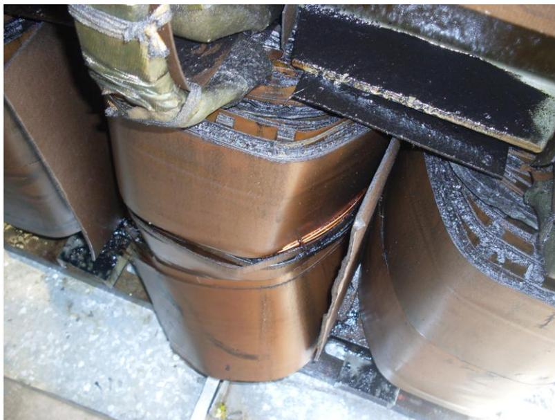
Figura 5.15 Bobina “vencida” por corto circuito entre sus espiras.
