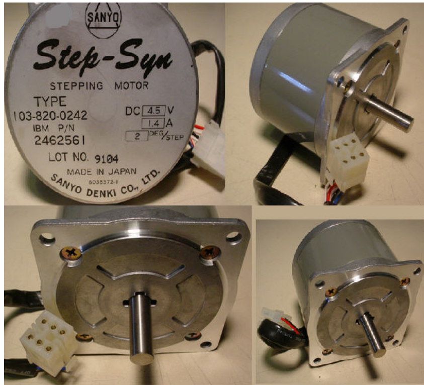
Figura 3.4 Fotografías del motor a pasos, híbrido - unipolar, marca Sanyo Denki, utilizado para el movimiento giratorio del gantry.
