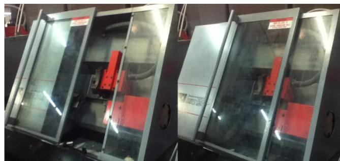
Figura 57, Puerta neumática torno.
