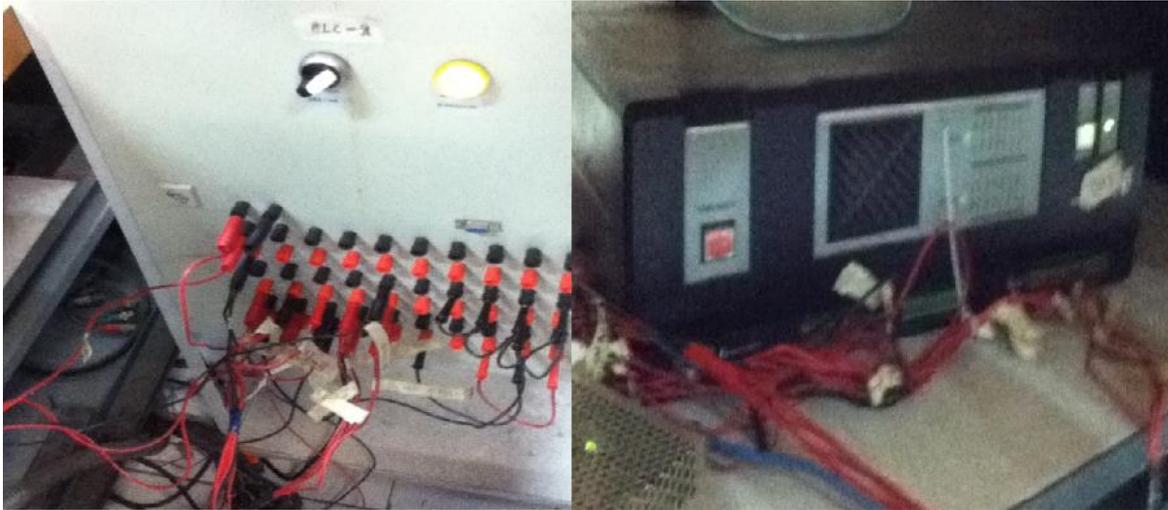
Figura 51. Conexiones realizadas entre PLC #2 y Controlador ACL #1.
