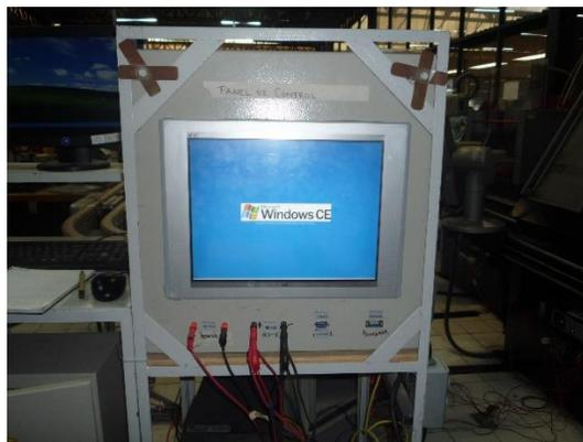
Figura 31. Interfaz humano máquina del laboratorio de manufactura avanzada. La pantalla LS XP90, es la computadora central CIM que provee un control centralizado de la producción SMF, y realiza la comunicación con las estaciones y
