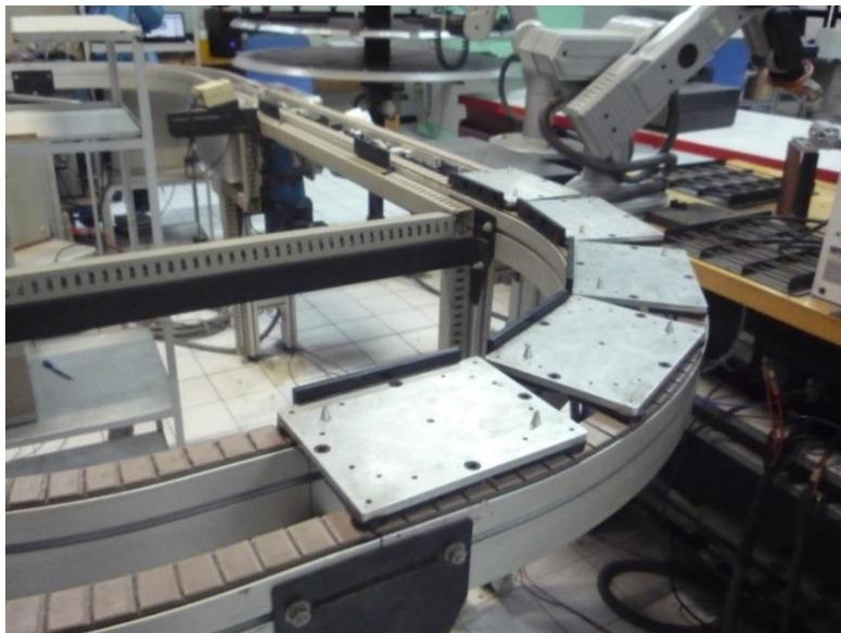
Figura 18. Pallets sobre la banda transportadora.
