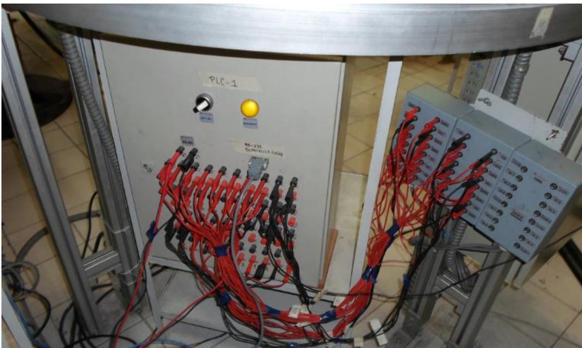
Figura 49. Conexiones de la caja de sensores al PLC#1.
