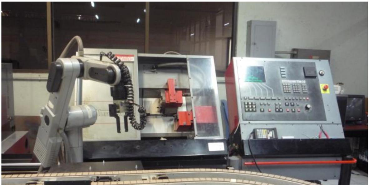
Figura 36. Torno de control numérico del laboratorio de manufactura avanzada.
