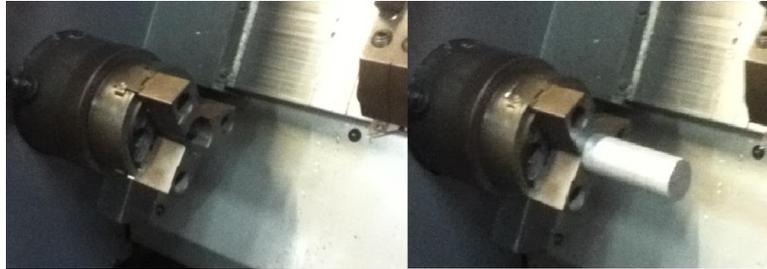
Figura 58. Chuck Neumático.
