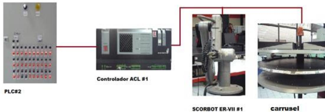
Figura 50. Dispositivos comunicados en la estación de almacenamiento.
