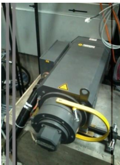
Imagen 4.1 Motor principal de una prensa XL75.
