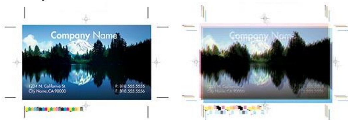
Imagen 1.18 Ejemplo de imagen en registro (izquierda) y la misma fuera de registro (derecha).
