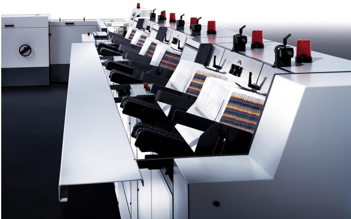
Imagen 1.28 Máquina automatizada para encuadernación grapada.
