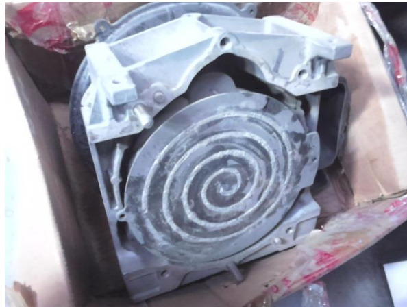
Imagen 4.6 Interior del compresor dañado.
