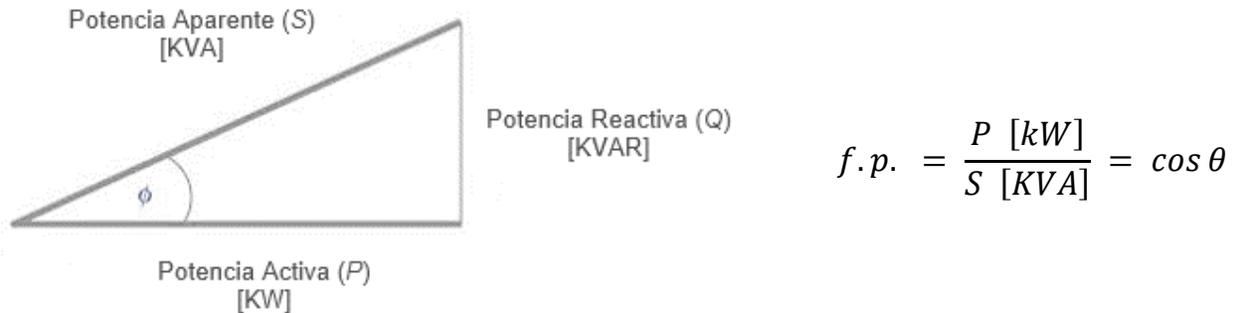
Fig. 6.10 – Triángulo de Potencia
