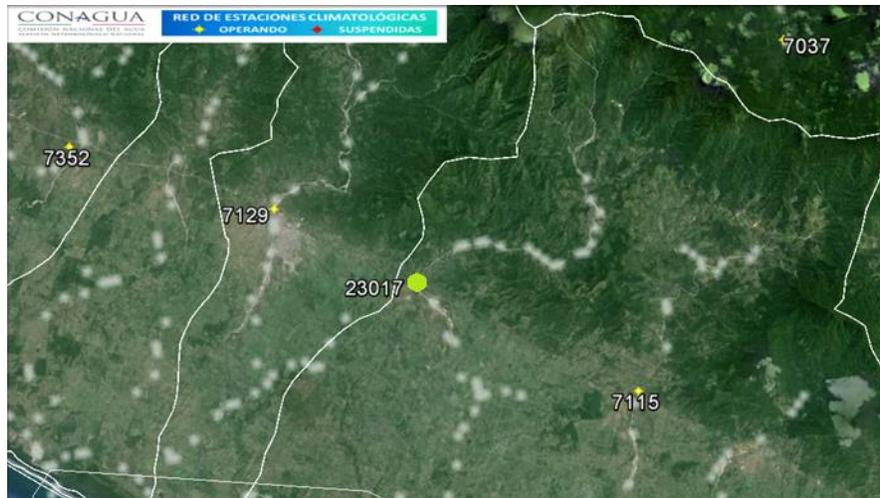
**Figura 6.22** Ubicación de las estaciones climatológicas usadas para el análisis de la cuenca de la estación hidrométrica 23017 (punto verde)
