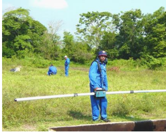
Figura III.5: Aplicación del método PEM en un área contaminada.
