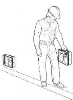
Figura III.4: Técnica inductiva de localización de ductos utilizando el equipo Fisher TW6.
