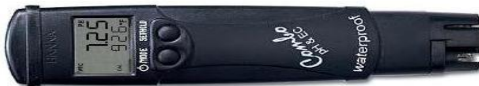
Figura III.11: Equipo Hanna HI98130 para el método MRA .
