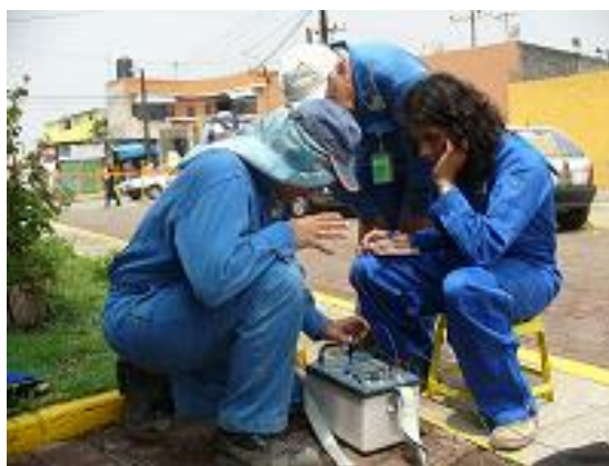
Figura III.7: Aplicación del método SEV en un área contaminada.
