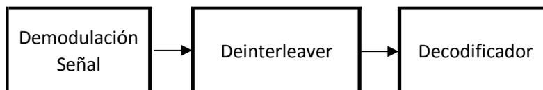
Figura 6.9 .- Diagrama a bloques de la etapa de decodificación
