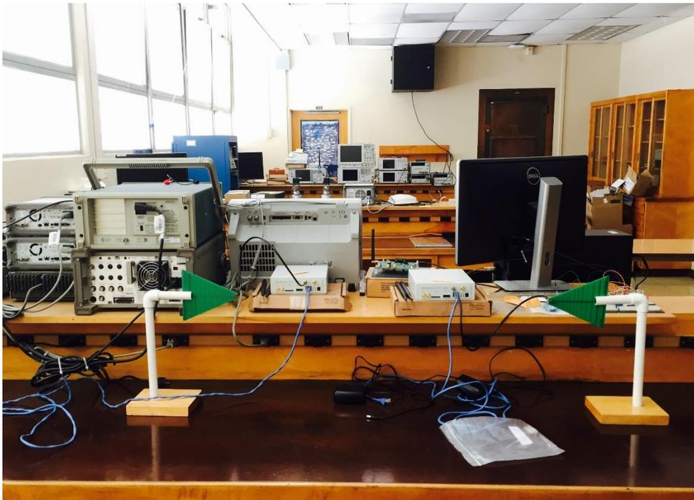
Figura 7.16 .- Primer escenario para la prueba del enlace inalámbrico OFDM
