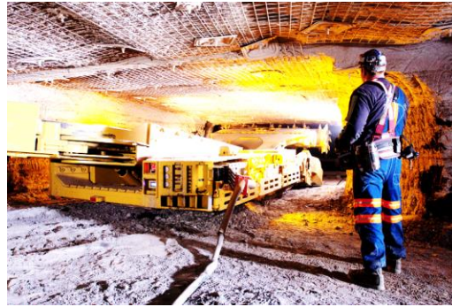
Figura 1.5 Minero continuo en operación
