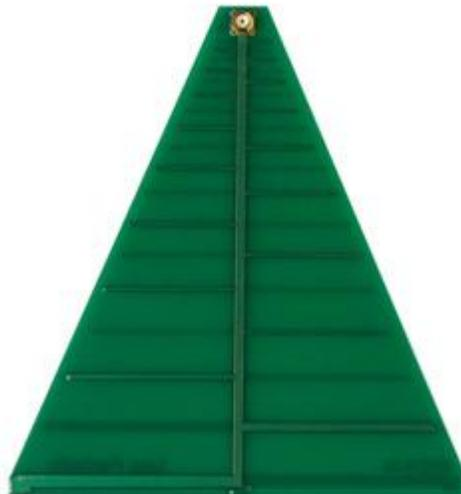
Figura 6.3 – Antena LP0965 de 850 MHz a 6.5 GHz.
