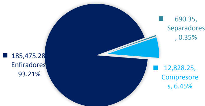
Figura 3.8. Trabajo perdido por tipo de equipo en los módulos de compresión de AKAL-B.
