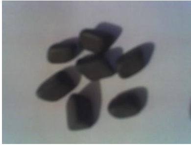
Ilustración 2.7.-Piedra utilizada para el matizado de partes chicas de latón, otro uso es el limpiado de otros metales mediante vibración.
