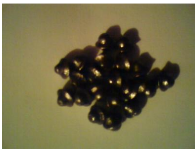
Ilustración 2.6.-Balín utilizado para el abrillantado de partes chicas de latón.
