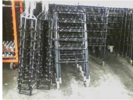
Ilustración 2.9.- Conjunto de electrodos y gancheras
