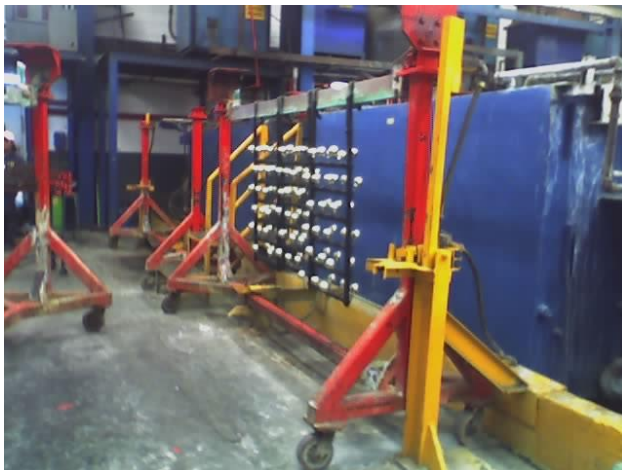
Ilustración 2.8.- Se muestra una tina y un RACK en donde se cuelgan los materiales a procesar para que se les de un proceso electrolítico.
