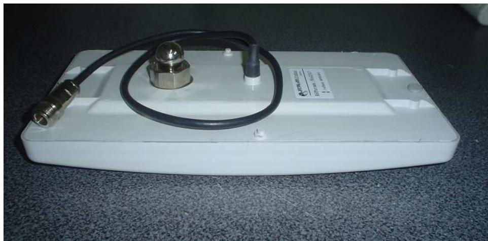
Figura 13. Antena de alta ganancia
